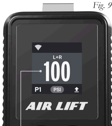
Ajuste de presión del puerto del resorte
